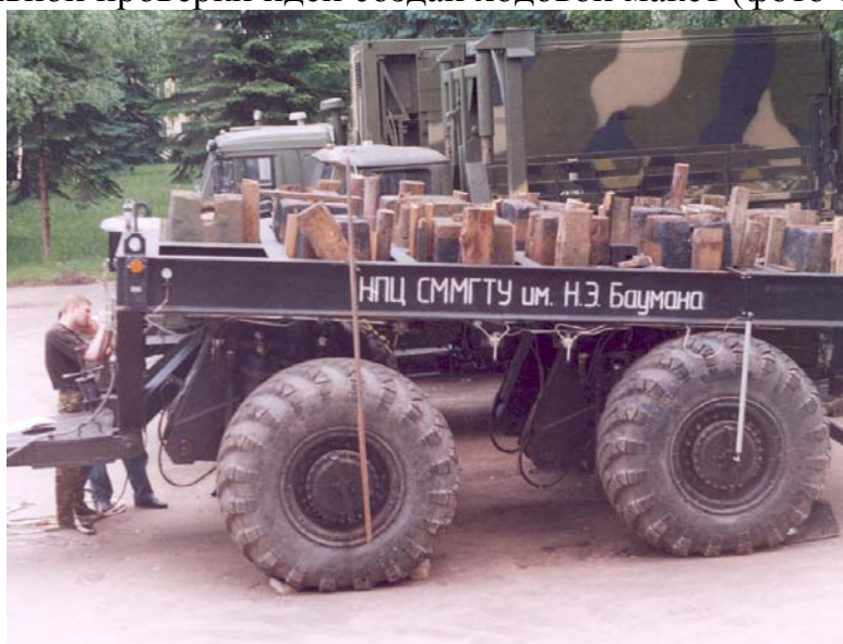
Фото.1 Ходовой макет, оснащенный ОХМ с длинноходной управляемой подвеской
