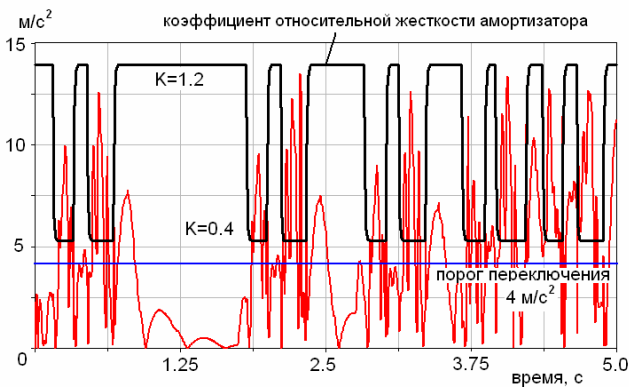
Рис.6. График переключения характеристик левого заднего амортизатора
